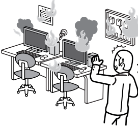
電気設備工事の絶縁ミスにより、 工事引渡し後に火災が発生し、 顧客事務所の一部と什器が 焼けてしまった。
