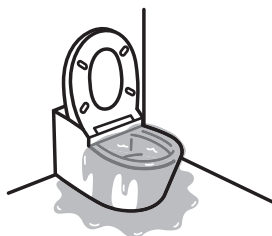
トイレの詰まり
