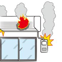
エアコン設置に伴う配線工事の施工ミスにより、引渡し後に火災が発生した。室内の壁面のほか、工事の目的物であるエアコンも損壊してしまった。
