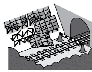
太陽光パネル設置工事引渡し後に、設置不良により線路沿いに設置していた太陽光パネルが崩れ落ちて損壊し、電車の運行に支障を来たすこととなり、電車が一時運行見合わせとなった。
