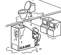
排水管の接続ミスにより、 工事引渡し後に漏水が発生。 階下のゲームセンターに 損害を与えてしまった。
